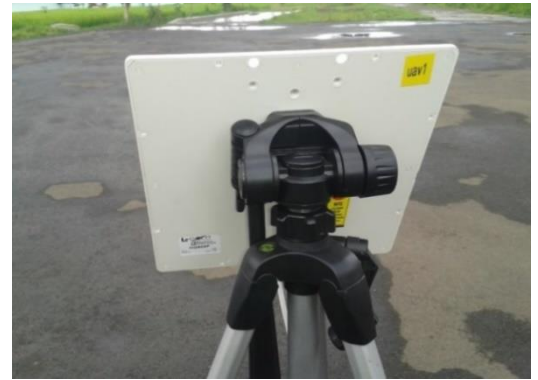
Gambar 9. Transmisi data menggunakan Flat Panel Antena Sumber: Dislitbangad, 2018
