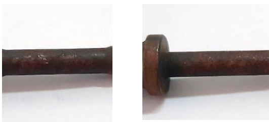
Gambar 1. Hasil Uji Korosi pada Komponen Senjata Ringan Manganese Phosphate Sumber; Hasil Olahan Peneliti, 2021
