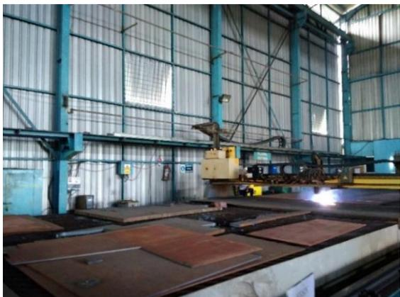
**Gambar 9.** Pemotongan Plat Baja Menggunakan Mesin CNC
