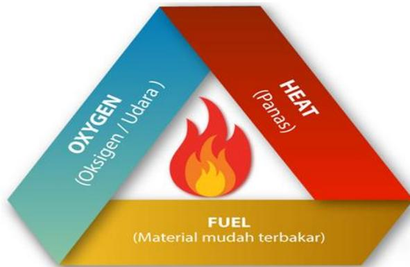
**Gambar 1.** Segitiga Api atau *Triangle of Fire*
