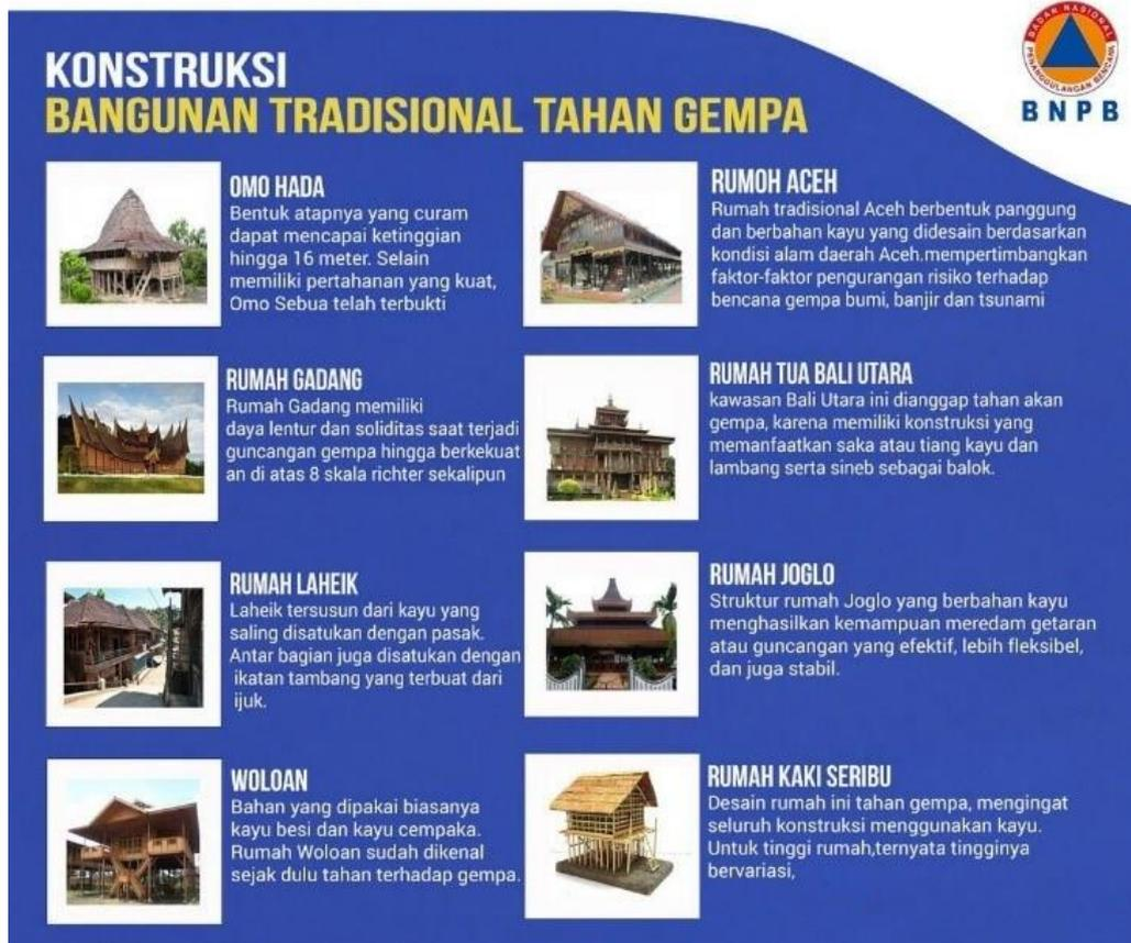
Gambar 2. Konstruksi Bangunan Tradisional Tahan Gempa
