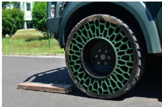
**Gambar 2. Ban Tanpa Udara.**
