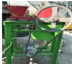
Gambar 7. Mesin Pemecah Biji Kemiri Sistem Impact Sumber: dokumen pribadi
