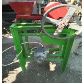
Gambar 2. mesin pemecah biji kemiri Sumber: dokumen pribadi
