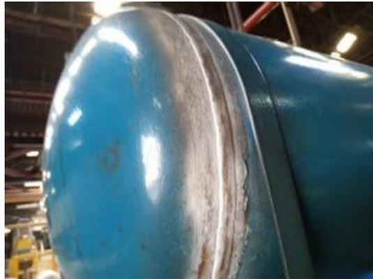
Gambar 1 Pengujian Penetrant Testing
