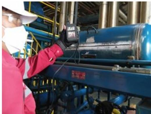
Gambar 2 Wallthickness pada Pelat Head
