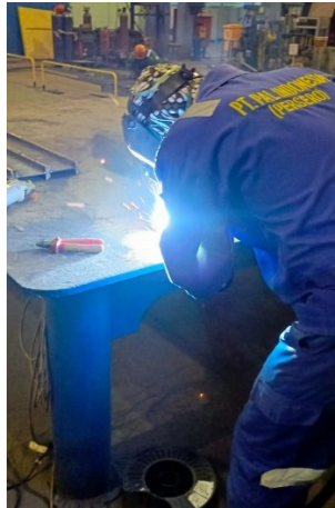
Gambar 4. Proses Pengelasan Ulang pada Bagian Hasil Gerinda Sumber: Dokumen Pribadi (2024)
