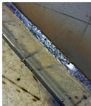
Gambar 2. Cacat Las Porosity pada Hasil Pengelasan Sumber: Dokumen Pribadi (2024)
