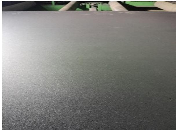
Setelah plat dan profil di blasting plat akan melalui treatment cat primer dengan menggunakan teknik spray bolak balik yang dilakukan secara bersamaan. Pada PT PAL sendiri menggunakan Jenis cat Jotun dan Internasional.
