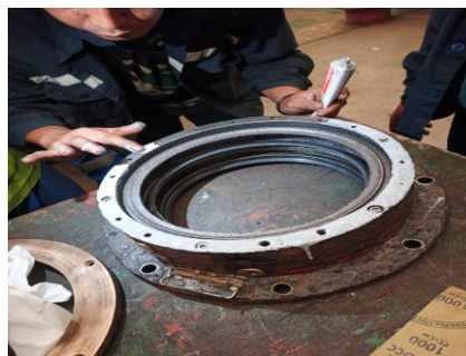
Gambar 8. Pengolesan treebon dan silicon red Sumber: Dokumentasi Pribadi
