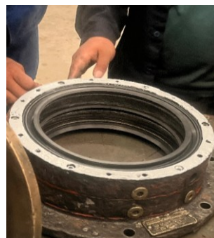
a. Rekondisi Pendedap AS Propeller b. Hasil Rekondisi
