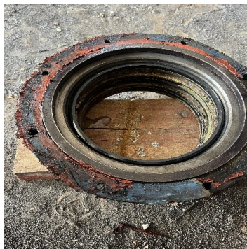
Gambar 2. Penedap As Propeller KM Pangrango Sumber : Dokumentasi Pribadi
