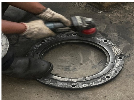
a. Rekondisi Pendedap AS Propeller b. Hasil Rekondisi
