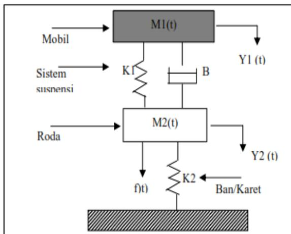
**Gambar 8.** Sistem Suspensi pada salah satu roda mobil
