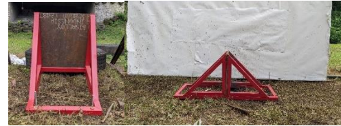
Gambar 2. Posisi plat baja pada dudukan
