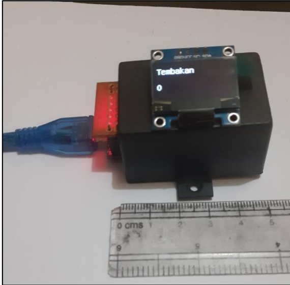
Gambar 7. Tampak Samping prototipe Penghitung Jumlah Tembakan Sumber: Diolah Peneliti, 2021
